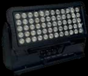
Aluminiumgehäuse schwarz, RGBW-Farben/4 in 1 LED - separat ansteuerbare Lichtreihen, Lichtquelle 60x10W, control mode: DMX512, 650W, IP65, Master-/Slave-Modus, Maße HxBxT, Preise per Stück
